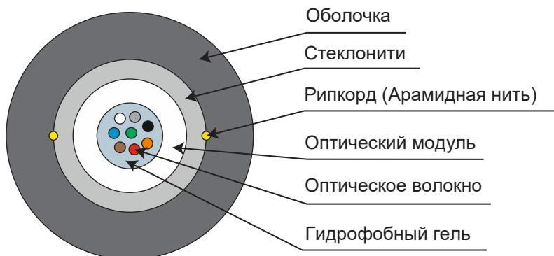
Кабель содержит оптический модуль со свободно расположенными волокнами. Свободное пространство в оптическом модуле заполнено гидрофобным гелем. Поверх модуля спирально накладываются упрочняющие стеклонити с водоблокирующим эффектом и оболочка из полиэтилена средней плотности. Под оболочкой кабеля продольно прокладываются два рипкорда.
