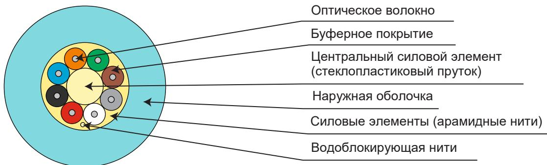
Кабель 4 ОВ содержит пучок оптических волокон в буферном покрытии и водоблокирующей нить, на которые наложен слой упрочняющих арамидных нитей с водоблокирующим эффектом.
